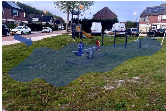
Multifunktionaler Platz wird bei Starkregen als Retentionsraum genutzt. Oben: Normalfall, Unten: bei Starkregen
